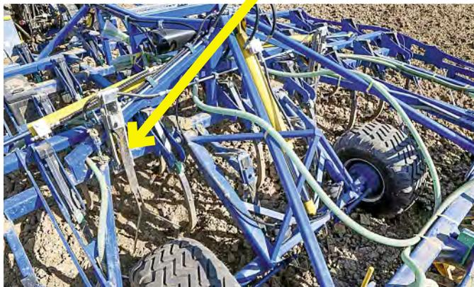
*Gut gelöst: Sobald die Achse hochgezogen wird, werden die beiden Hardox-Zustreicher vor den Rädern hydraulisch unter die Pneu geschwenkt.*
