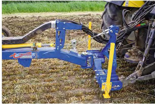
Bei unserem Fahrerbericht musste der Oberlenker vom Schlepper für den Zugkraftverstärker weichen (linkes Bild). Mittlerweile hat Treffler das System geändert, jetzt kann der Oberlenker bleiben (rechts).
