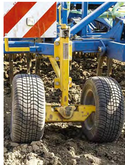
*Vorne wird die Arbeitstiefe über vier Pendelstützradpaare geführt.
