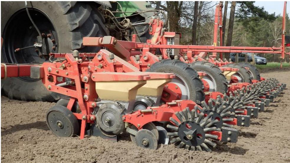
**Abb. 5:** Einzelkornsäegerät mit Fingerdruckrollen
