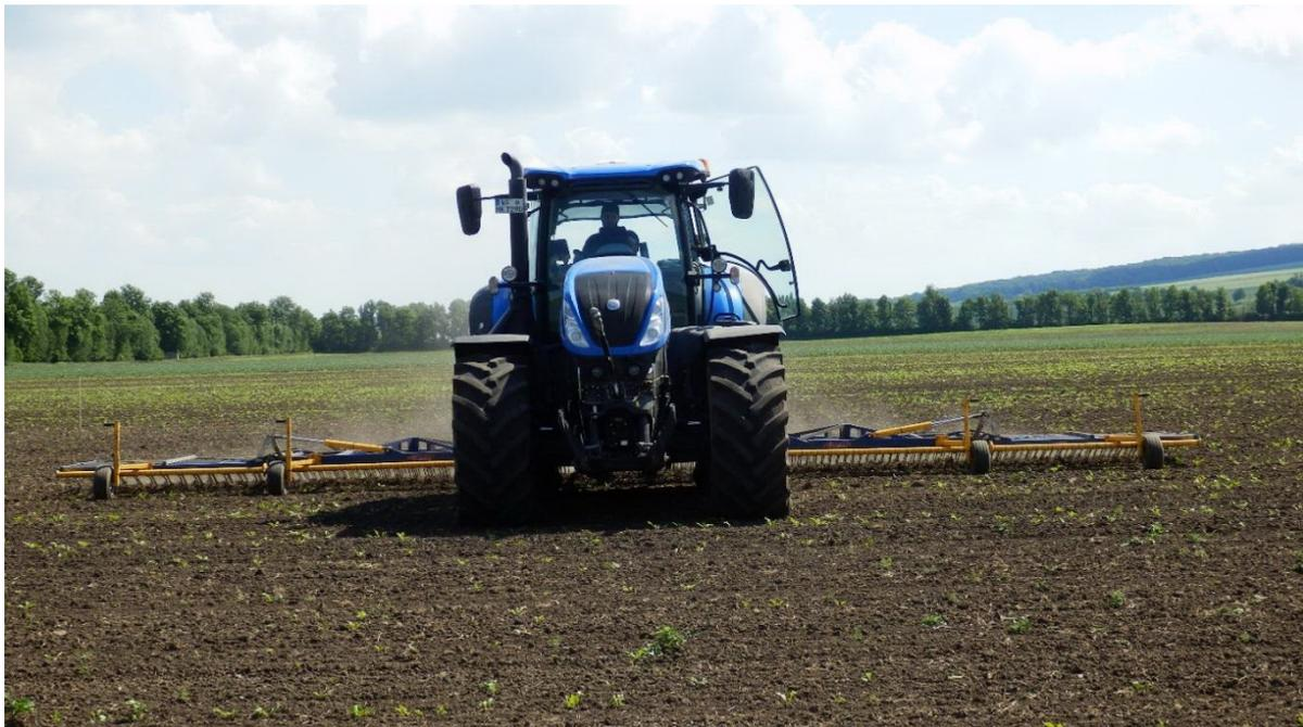
**Abb. 19:** Striegeln quer zur Särichtung mit Breitreifen und 0,6 bar Reifendruck
