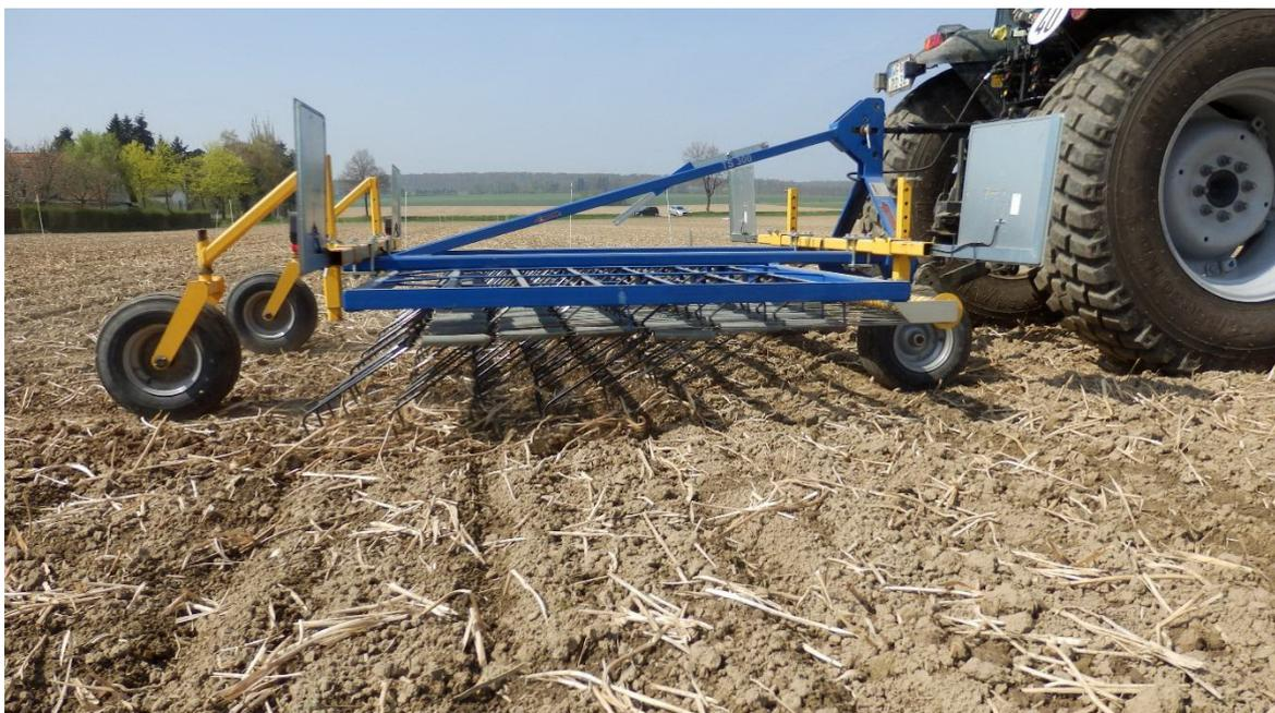
**Abb. 14:** Beim Querstriegeln im Keimblattstadium sind erhöhte Rübenverluste zu erwarten. Gut sichtbar sind die Särillen der Fingerdruckrolle
